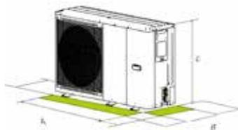
Per un buon funzionamento dell'unità è fondamentale che vengano mantenute le distanze di rispetto indicate dalle aree verdi.
